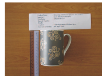
Contoh cawan seramik dengan perhiasan dan permukaan berkilat yang mengandungi kandungan plumbum yang tinggi dan tidak mematuhi tahap keselamatan MS 1817: 2005
